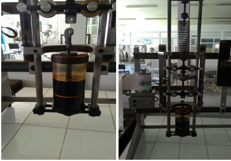
Şekil 6: Deneysel Düzenek sönümlenme sistemi (solda), tüm sistem (sağda)
