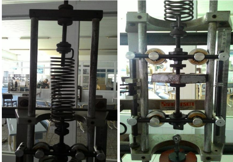
Şekil 6: DeneySEL Düzenek yay (solda), yaya bağlı kütle (sağda)
